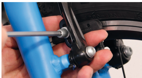
Align brake pads
